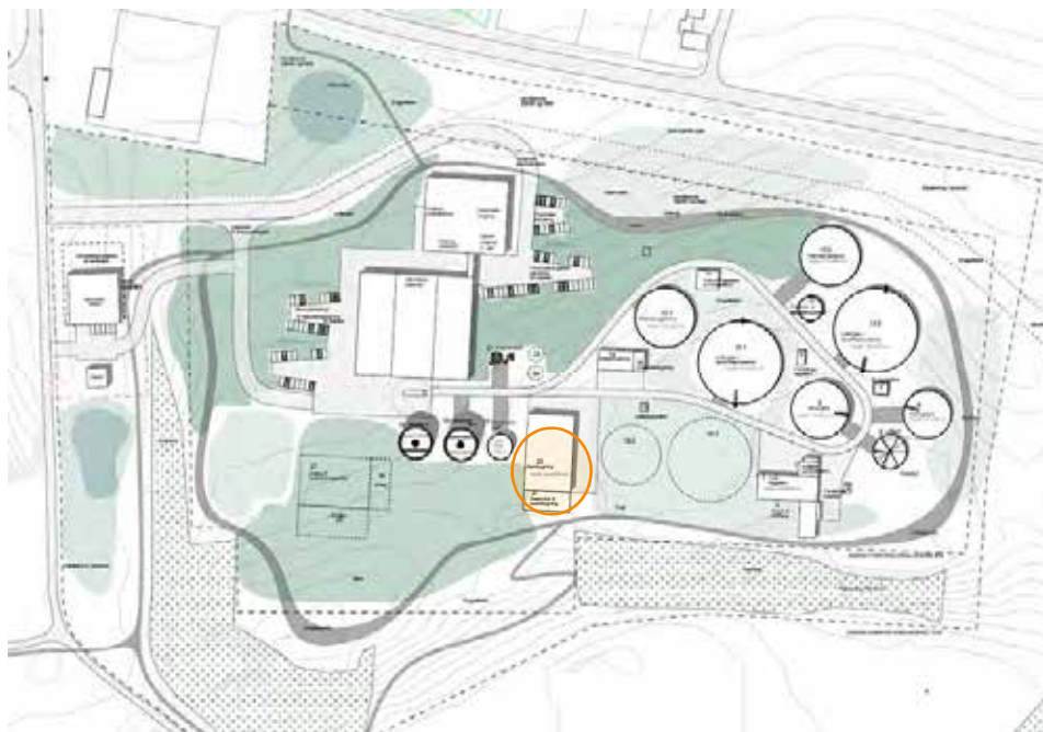
Figur 2-2 Placering af renseanlæg og afkast på grunden. Luftafkast placeres i området ved slambehandling og gasmotor/kedelbygning som vist med cirkel på kortet.
