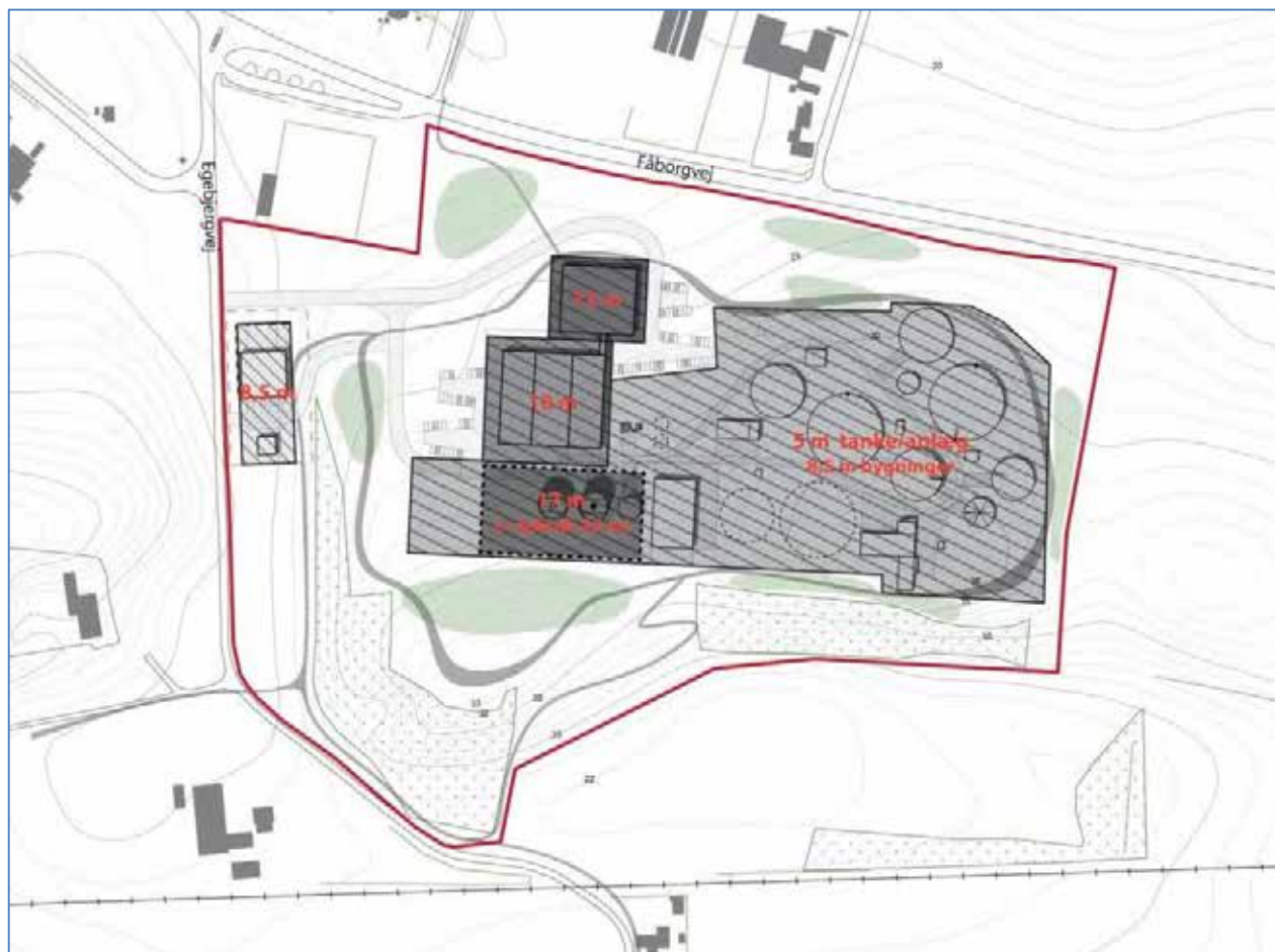
Figur 3.3 Illustration af byggefelter og byggehøjder.
