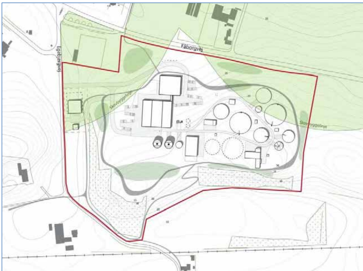
Figur 3.2 Placering af renseanlæg og vandværk samt adgang til området. På figuren er skovbyggelinjen indtegnet (grønt område). Indtegnet på baggrund af: (Assens Forsyning, 2016)
