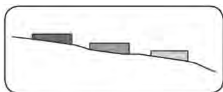
Figur 5.15 Princip for hvordan procestanke kan variere i farvetone i samspil med terrænet.
