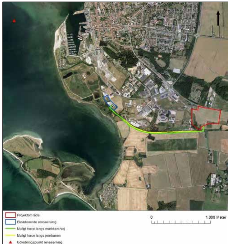
Figur 3.5 Tracé af ledninger mellem de 2 renselanlæg.
